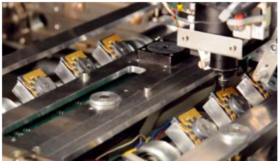
Mehrfachnutzenträger für MID (Quelle: Lehrstuhl FAPS)
