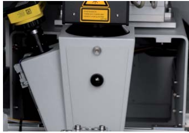
Markiertrichter für definierten Absaugbereich
