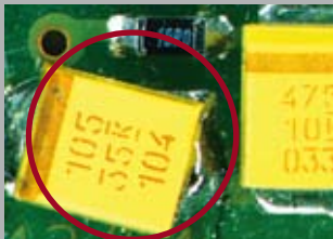
Bestückfehler Tantal- Kondensator
