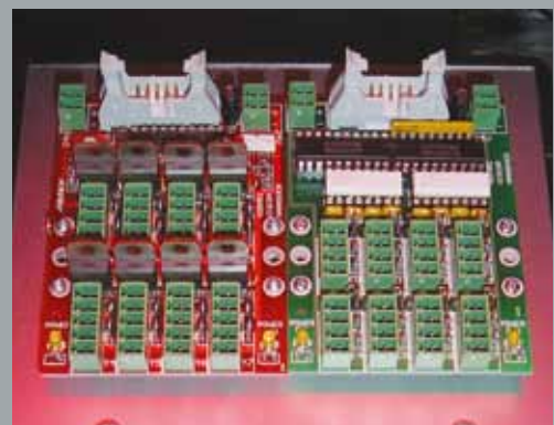
Leiterplatten mit selektiv gelöteten Bauteilen
