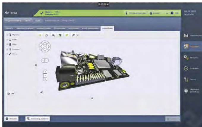
ODB++-Daten ermöglichen fotorealistische Darstellung der Baugruppe im 3D-Format.
