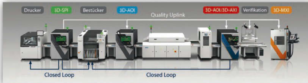
SMT Produktionslinie mit verschiedenen Inspektionssystemen.
