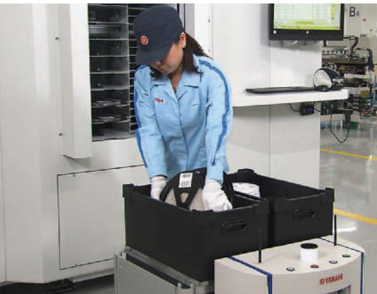
Bauteile aus dem SMD-Lagersystem werden mittels fahrerlosem Transportsystem (FTS) an die Montagelinie gebracht.
