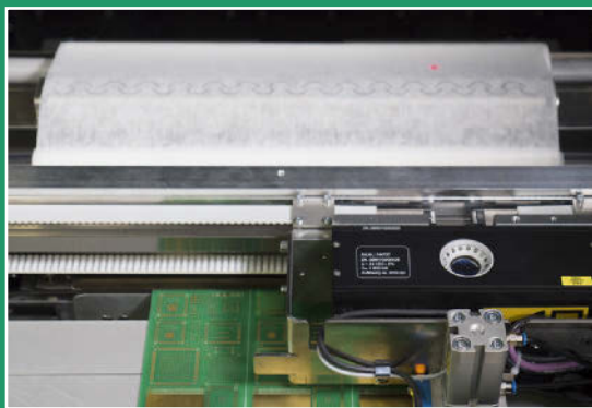
Bild 7: Alles aufeinander abgestimmt: Schablonenunterseitenreiniger und Flächenkamera des Versaprint 2 Elite sorgen für effiziente Prozesse.
