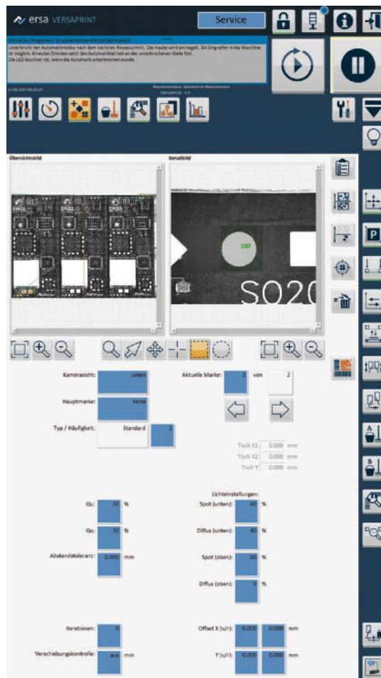
Bild 2: Das Markenmenü der neuen Softwareoberfläche. Anwender kommunizieren via Touchscreen mit der Maschine.
