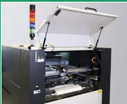
Bild 4: Eine vollwertige Haube statt der bisherigen Zugangsklappe erleichtert den Reinigungsvlieswechsel.
