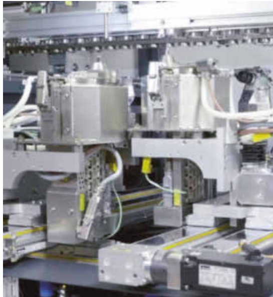
Versaflex-Modul – zwei unabhängige X/Y-Achssysteme mit Fluxköpfen bzw. Löttiegeln erlauben größtmögliche Flexibilität in der Programmierung
